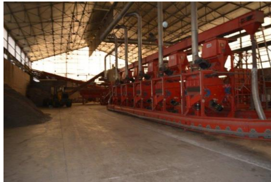
Figure 25 : Tables densimétriques en parallèle
