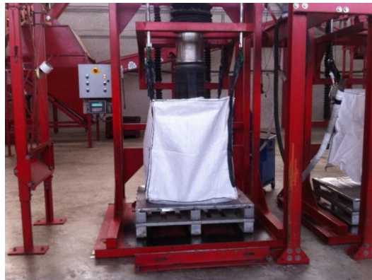
Figure 26 : Répartition et chargement des big-bags
