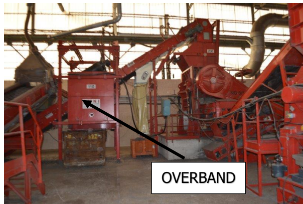
Figure 13 : Overband positionné sur le convoyeur avant le granulateur
