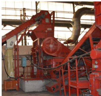
Figure 21 : Granulateur avec grille de 20mm
