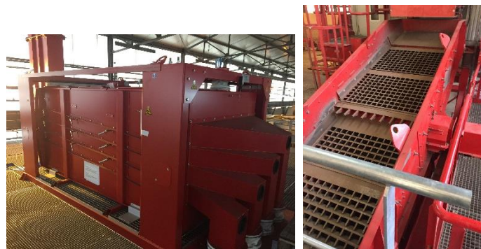
Figure 19 : crible vibrant et crible à mailles
